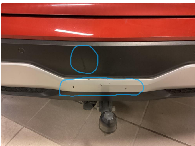
1.3 Ripe(r) ned til grunning
