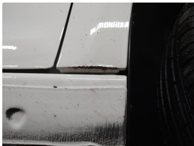
1.3 Steinsprut med rust
