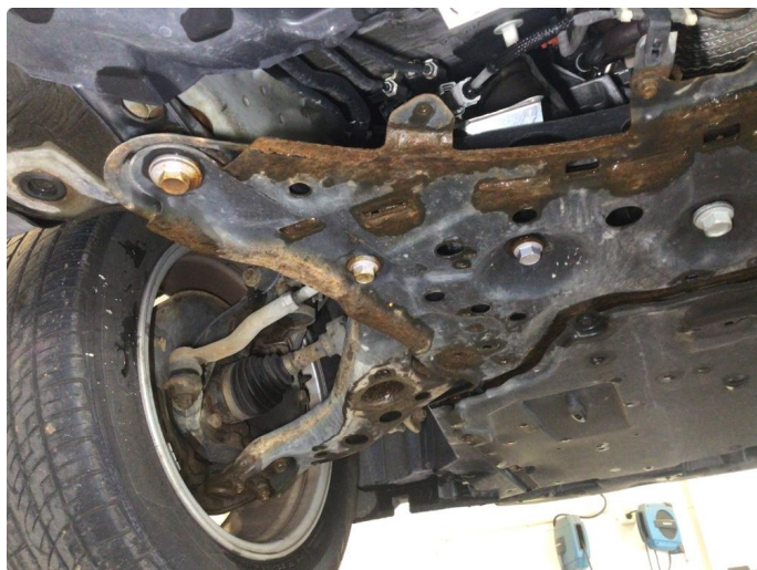
2.1 Overflaterust i forstilling, ingen tiltak kreves
