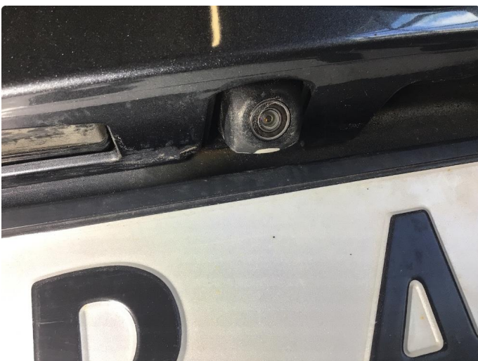
1.2 Noe korrosjon under kameralinse på bakluke
