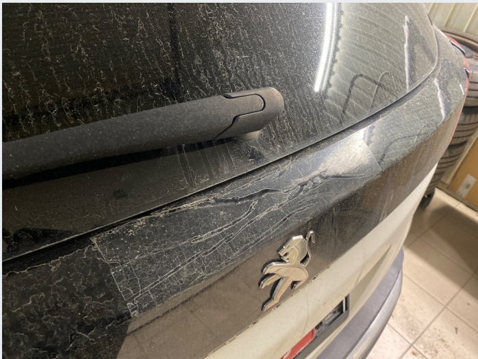
2.5 Sprukket plastikk bakluke
