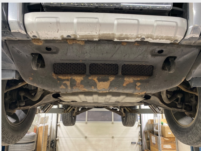
2.2 Rust under bil
