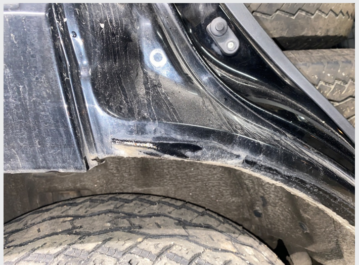
2.5 Påbegynnende rust døråpning høyre bak
