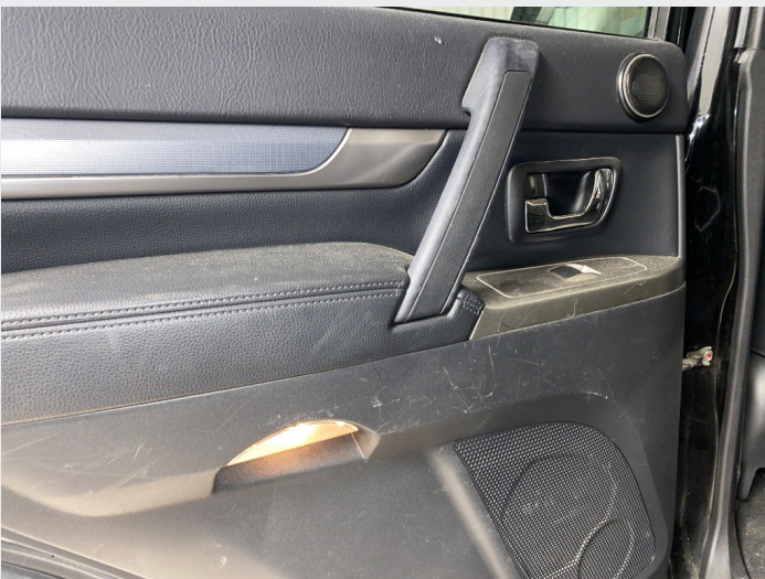
4.4 Slitasje dørtrekk venstre bak.
