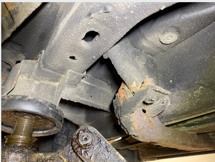
2.2 Rust under bil
