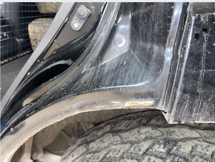
2.5 Påbegynnende rust døråpning venstre bak
