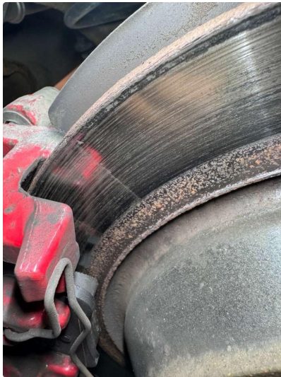
2.1 Rust, blir byttet 18/9
