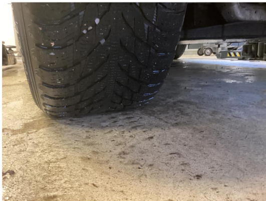
1.1 Skjev slitasje på vinterdekk
