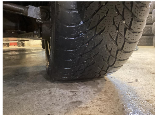
1.1 Skjev slitasje på vinterdekk
