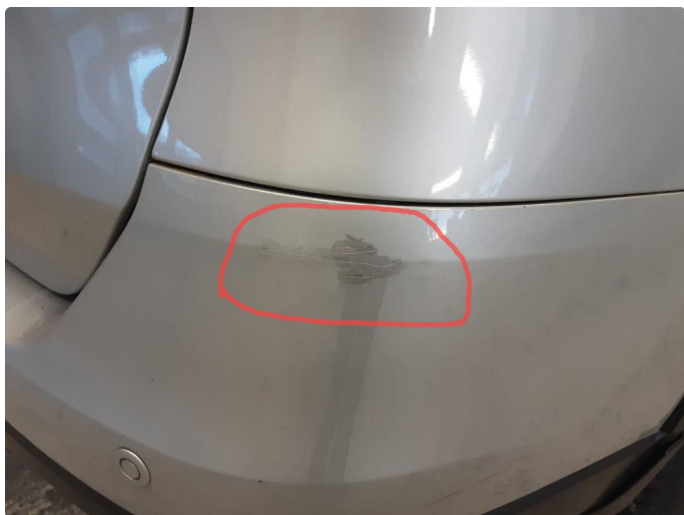
1.12 Ufagmessig utført arbeid
