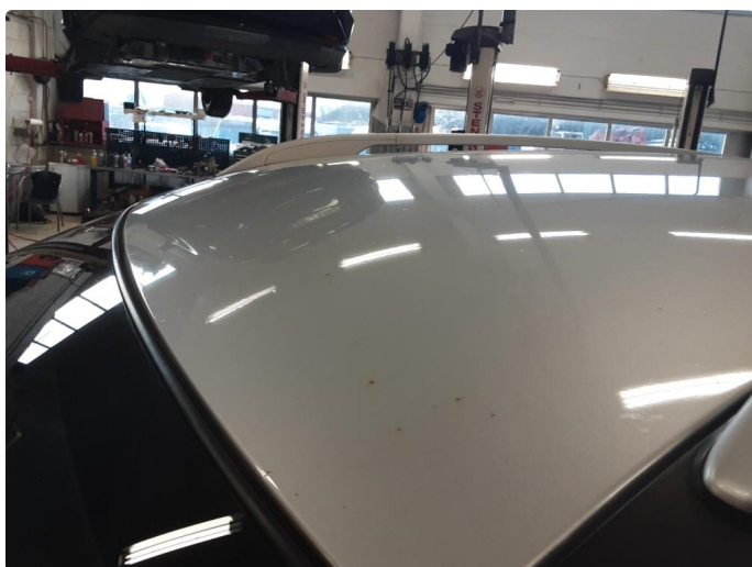
1.14 Steinsprut med rust
