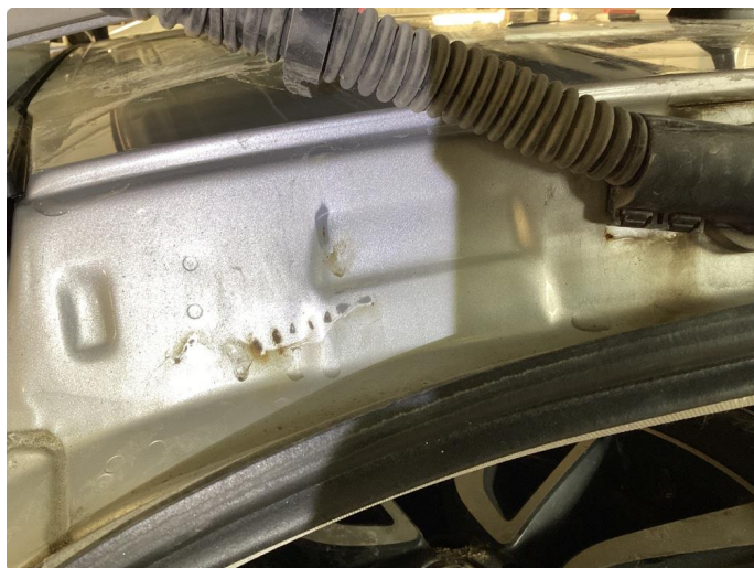
1.13 Ripe(r) ned til grunning
