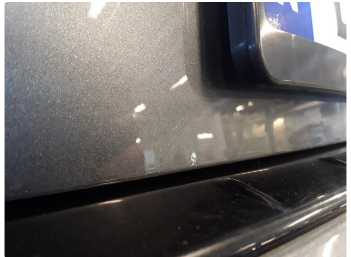
1.4 Liten steinsprut med korrosjon.
