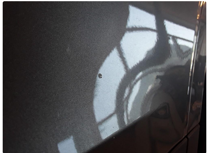
1.3 Liten steinsprut med korrosjon venstre bakdør.
