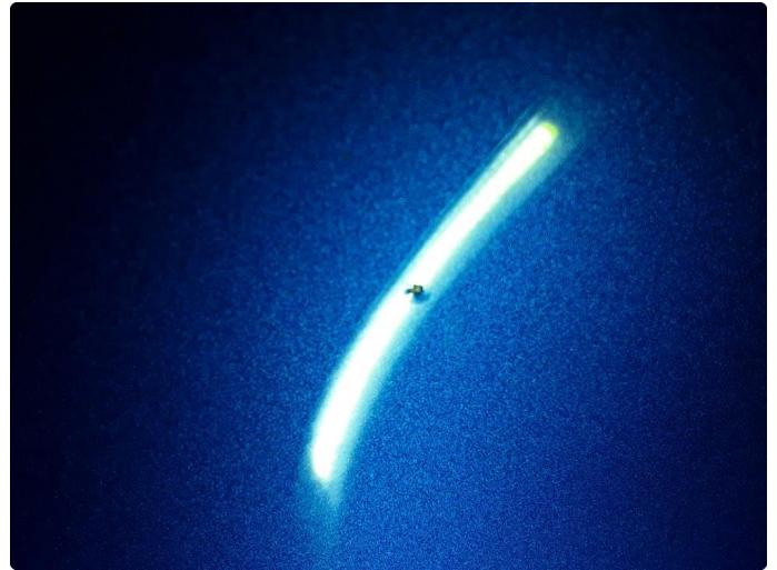
1.2 Liten steinsprut med korrosjon.
