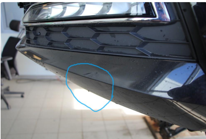
1.4 Liten skade langt ned på fanger. Subberiper under fanger.
