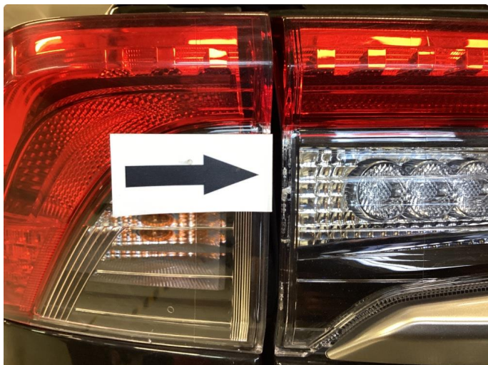
1.1 Krakelering i plast. VURDERES VED SALG.
