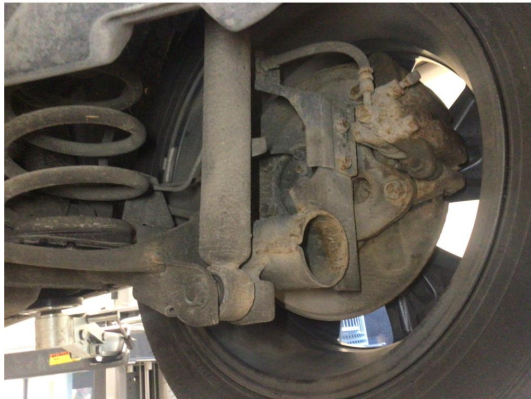
2.1 Overflaterust i bakstilling, ingen tiltak kreves
