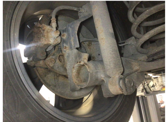
2.1 Overflaterust i bakstilling, ingen tiltak kreves
