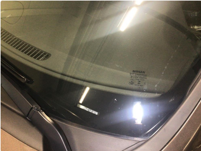
1.1 Noe små steinsprut på frontvindu, dette av ubetydelig karakter
