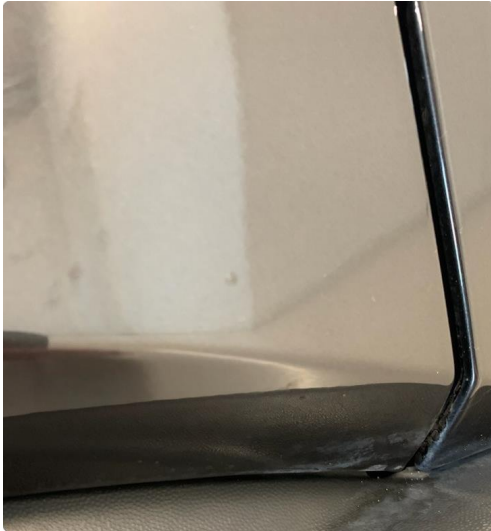
1.2 Liten steinsprut med korrosjon høyre fordør og høyre bakdør.
