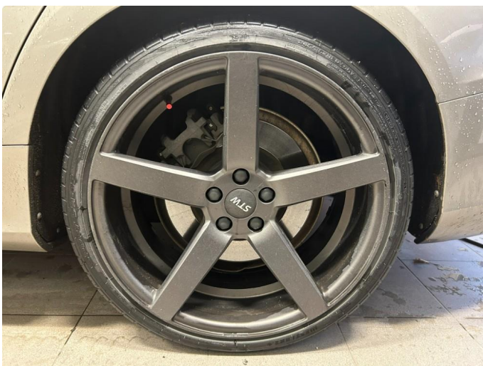
1.4 Skade på felg (litt kantkjørt)
