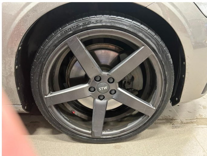
1.4 Skade på felg (litt kantkjørt)
