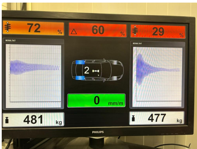
2.1 Støtdemper defekt (byttes før salg)
