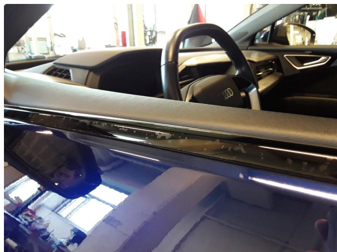
1.2 Noe misfarget lister.
