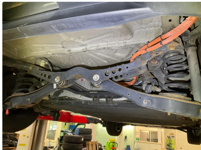
1.1 Rust, normalt ihht alder og km, anbefaler behandling for å bevare kvalitet og funksjon over tid
