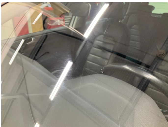
1.8 Steinsprut i synsfelt, er reparert
