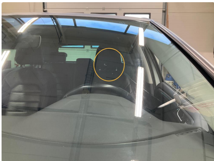
1.8 Steinsprut i synsfelt, er reparert
