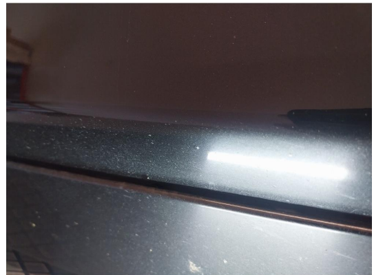
1.2 Steinsprut med rust
