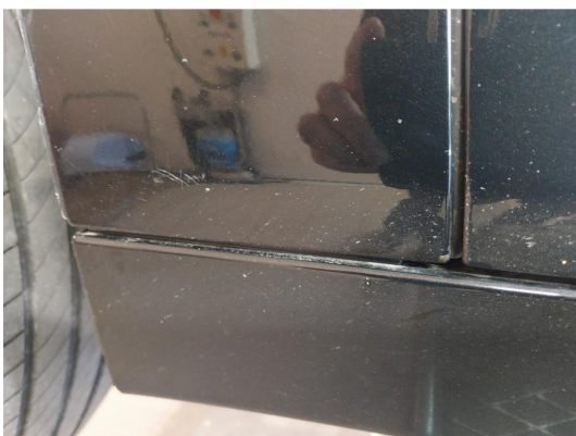
1.3 Steinsprut med rust
