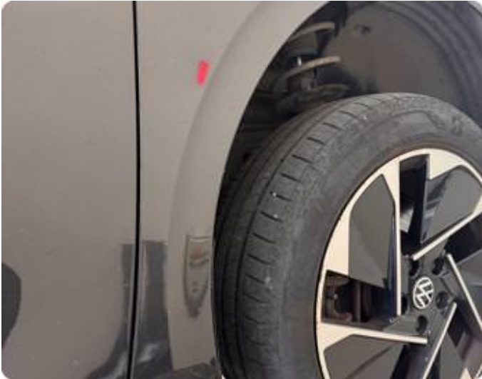
1.2 Liten steinsprut med korrosjon.
