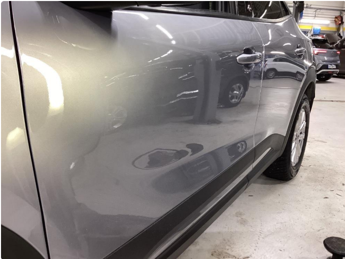
1.1 Lakkert med Smart Repair/spotlakking, noe ujevnhet/fargeforskjell finnes i lakk.
