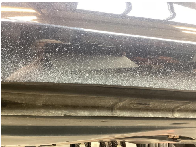
1.2 Noe slitt lakk nedre del dører
