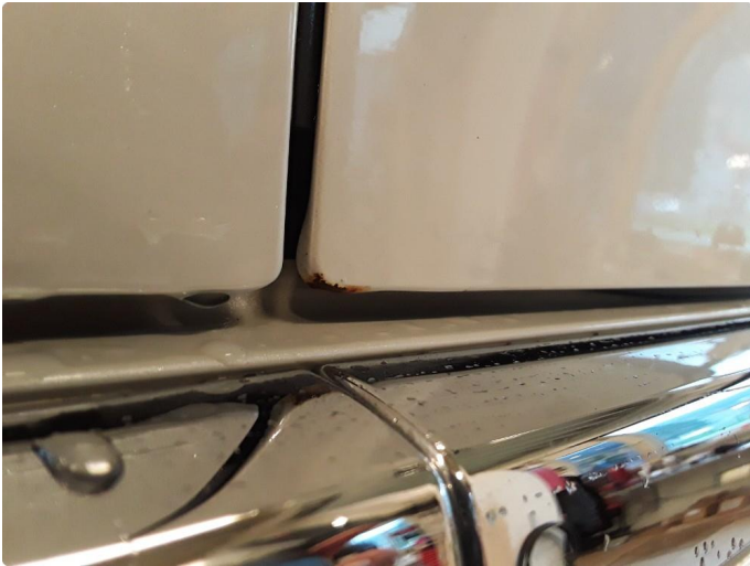
1.3 Noe steinsprut med korrosjon høyre fordør.
