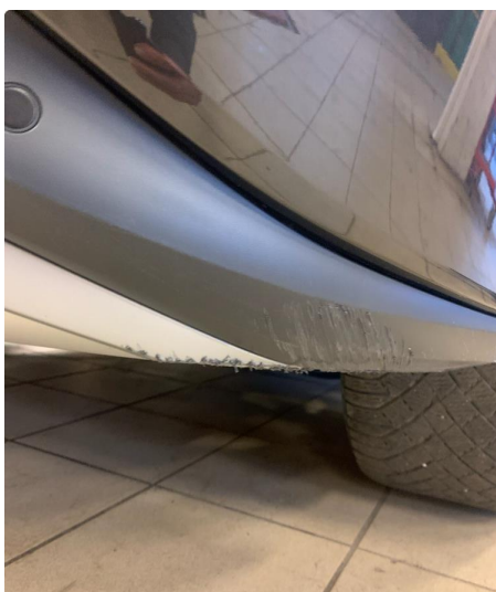
1.4 Noe riper underkant av støtfanger bak.
