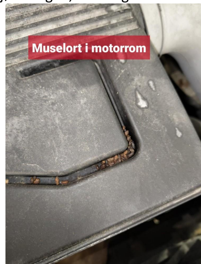
3.4 Muselort på luftfilterhus i motorrom
