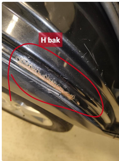
2.5 Rust i døråpning, h. bak
