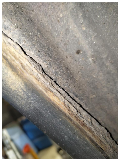
2.2 Rust i hjulbuer
