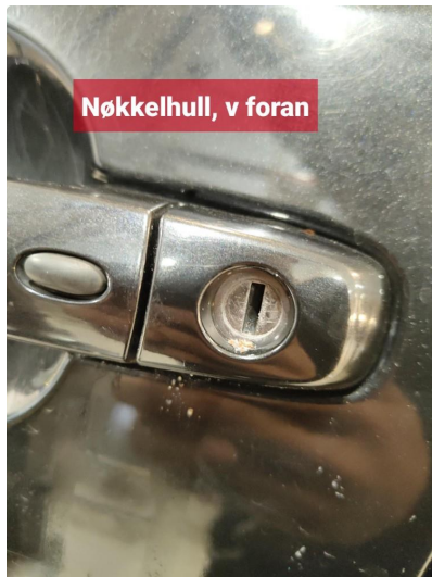
1.1 Nøkkelhull, førerdør, defekt
