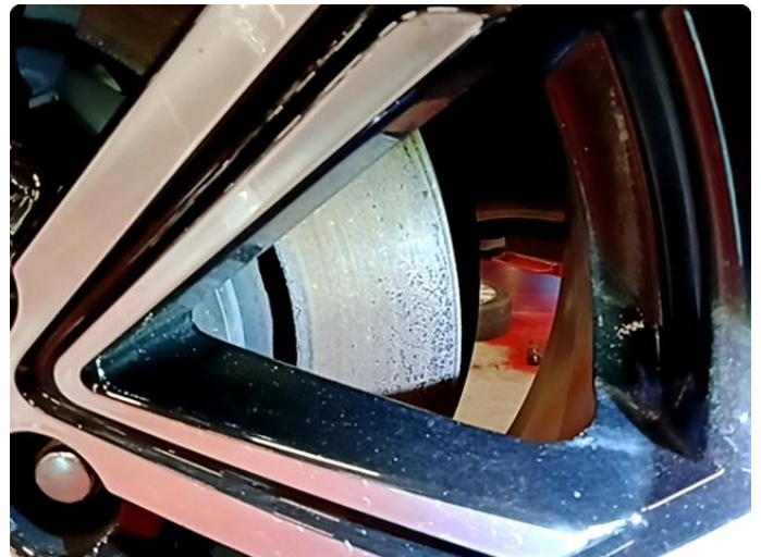
2.1 Rust på alle bremseskivene
