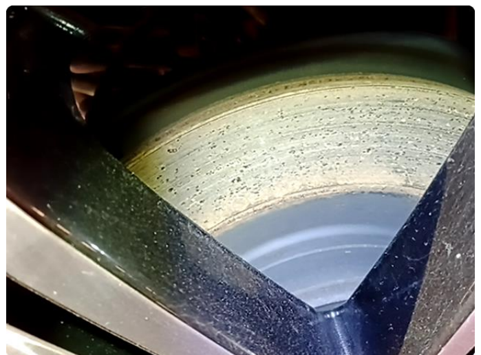
2.1 Rust på alle bremseskivene
