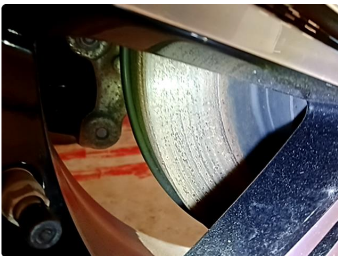
2.1 Rust på alle bremseskivene
