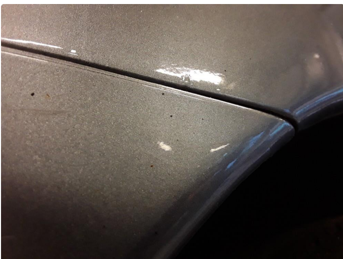
1.5 Bulk med korrosjon.
