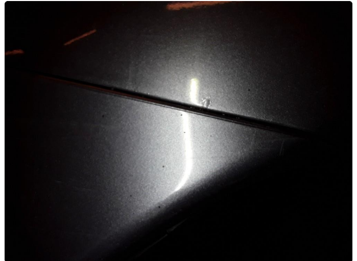
1.5 Bulk med korrosjon.
