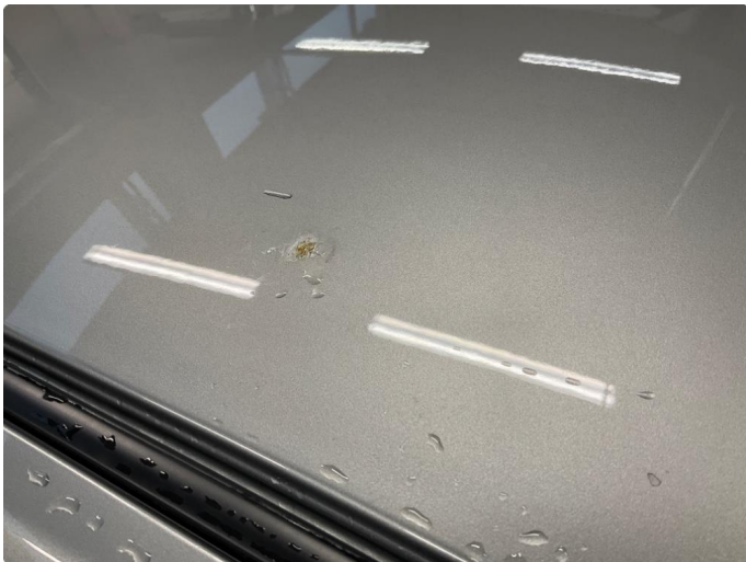
1.1 Steinsprut med rust, er penslet.
