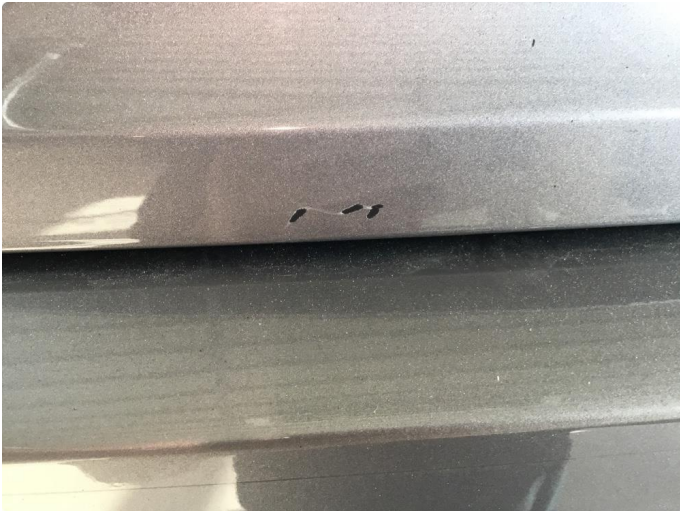
1.1 Ripe ned til grunning
