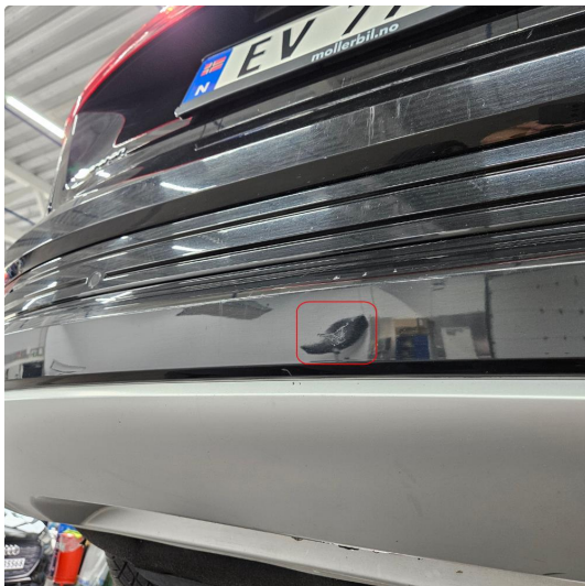
1.3 Div bruksmerker/småbulker i plast-støtfanger bak, nedre
