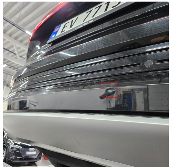
1.3 Div bruksmerker/småbulker i plast-støtfanger bak, nedre
