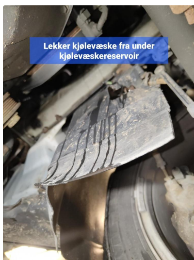
3.2 Kjølesystem lekker fra under reservoar til kjølevæske og mellom motor og girkasse
