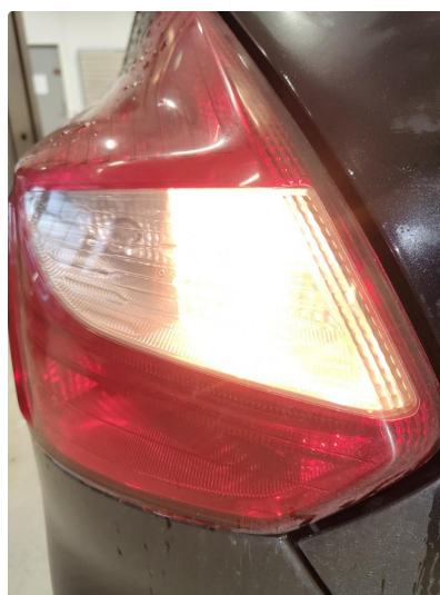
2.1 Begge blinklyspærer bak er godt brukt og oransje fargen er borte, blinklys lyser hvitt
