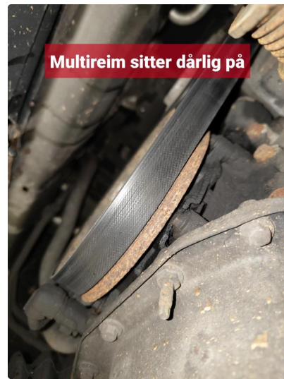
3.6 Forrige eier har montert multireim for bil uten AC, for AC kompressor står helt fast i sveiven. Multireimen sitter feil og er ikke riktig del
