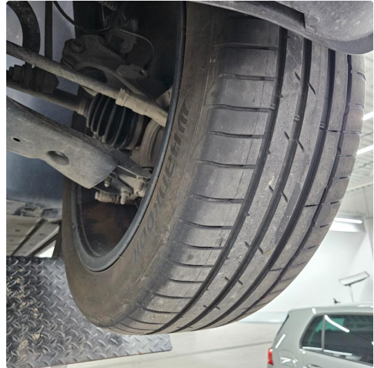
1.1 Noe kantslitasje på innside, sommerdekk - bilen leveres med firehjulskontroll utført for å hindre at denne slitasjen forverrer/utvikler seg
