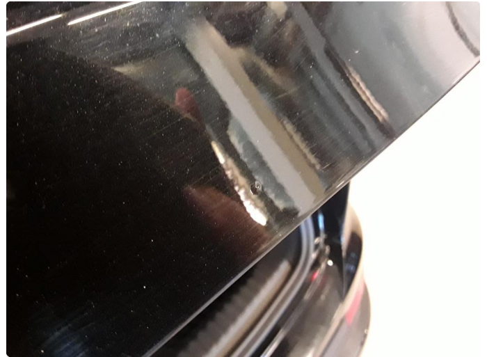
1.2 Liten steinsprut med korrosjon.
