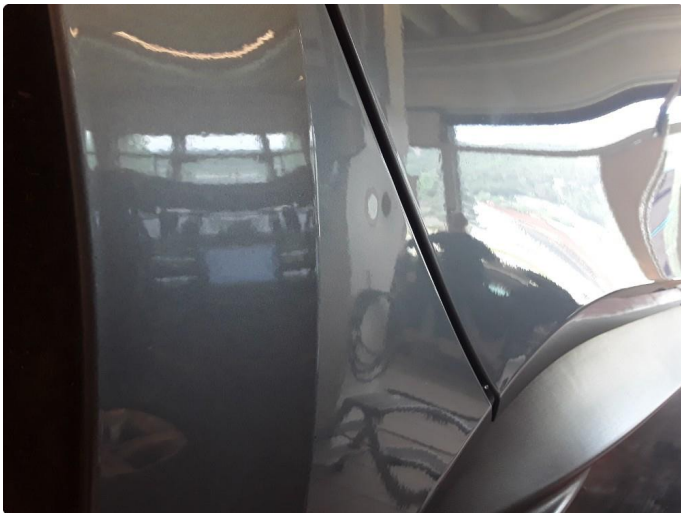
1.2 Liten bulk høyre bakskjerm. Blir forsøkt med bulkfix.
