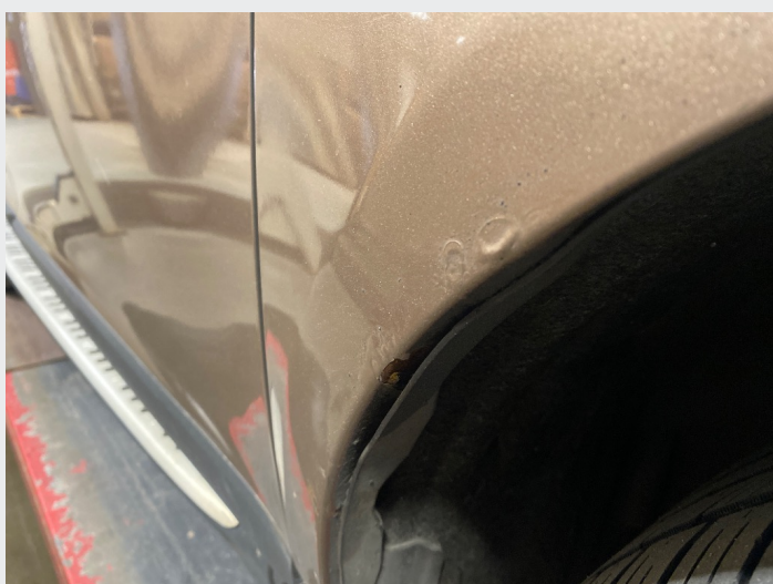
2.7 Rustbobler/rust hjulbue høyre foran
