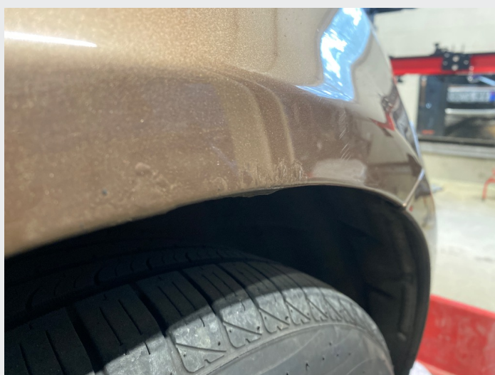
2.7 Rustbobler/rust hjulbue høyre foran
