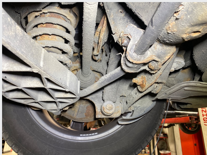
8.5 Det finnes rust i for og bakstilling
