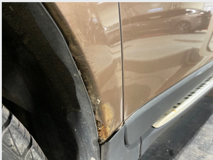
2.7 Rust hjulbue venstre foran
