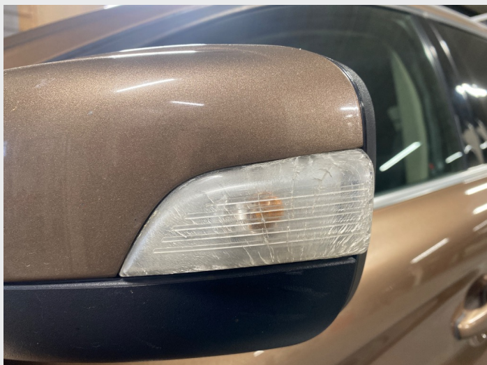
3.4 Sprukket blinklys på speil venstre side
