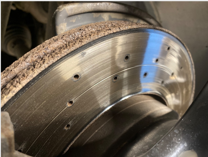
9.7 Bremseskiver foran må påregnes bytte ved neste klossebytte pga slitasje
