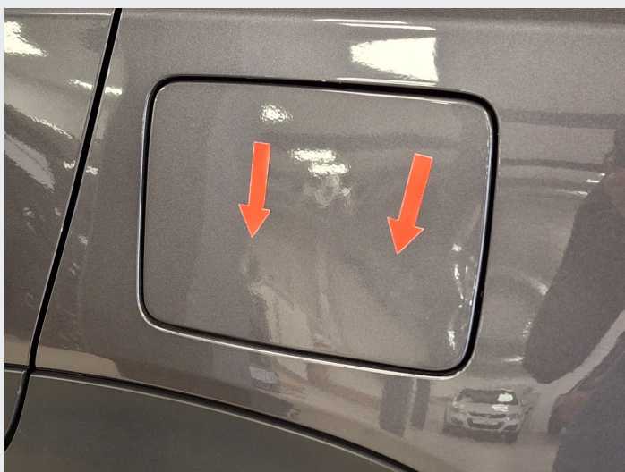
2.1 2stk små bulker på tanklokk
