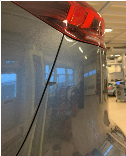
1.2 Liten ripe venstre side og nedre midtre del av støtfanger bak.
