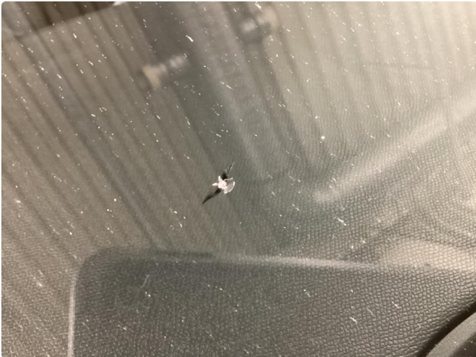
1.1 Steinsprut høyreside frontrute, EU OK
