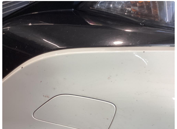
1.3 Ripe og steinsprut på front fanger
