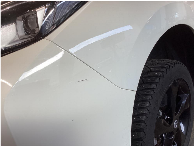
1.3 Ripe og steinsprut på front fanger
