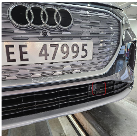
1.1 Knekt plast-spile på grill, nede i støtfanger, v.side foran
