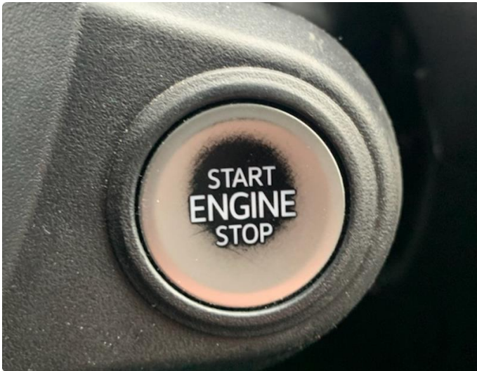
2.1 Noe slitasje på start knapp.
