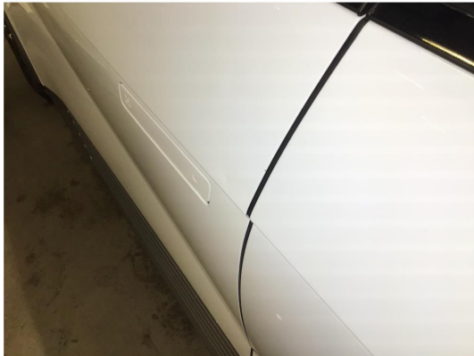
1.1 Liten parkeringsbukk venstre bakdør. Blir utbedret før lev
