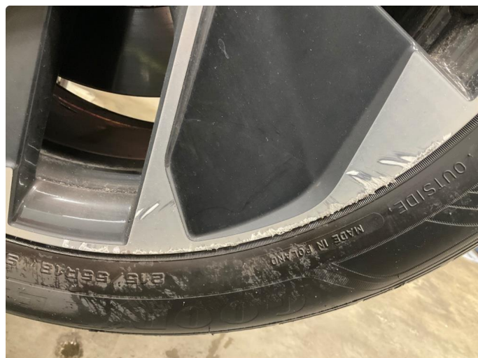
1.1 Riper på felg
