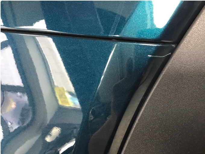
1.2 Ripe ned til grunning
