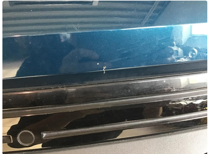
1.2 Ripe ned til grunning
