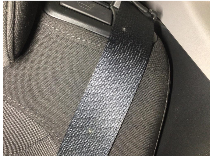
2.1 Små slitasjemerker på bilbelte venstre side bak
