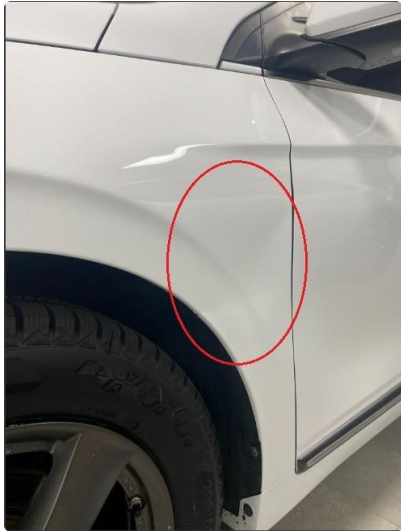
1.1 Bulk venstre framskjerm. Vil bli noe utbedret med smartrepair
