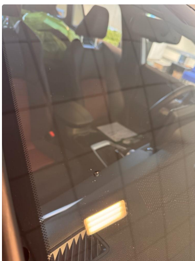
1.3 Steinsprut i frontrute, skal repareres før salg
