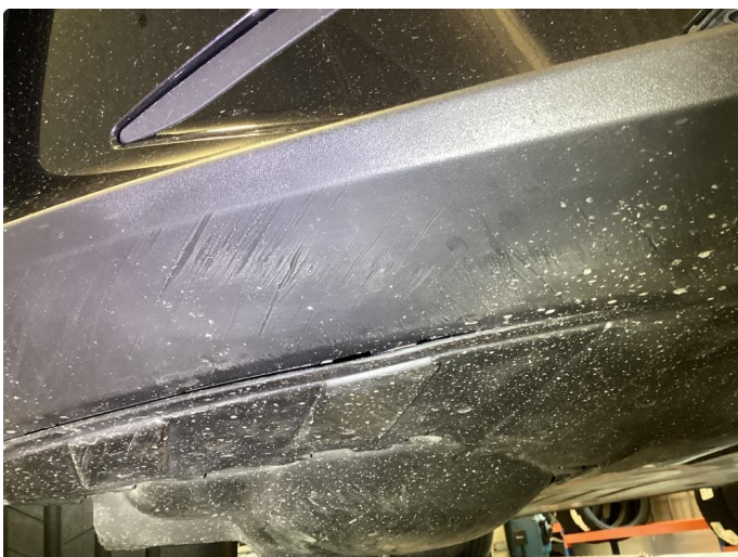
1.3 Øvrige feil liten sprekk i innerskjerm/bunndeksel høyre side
