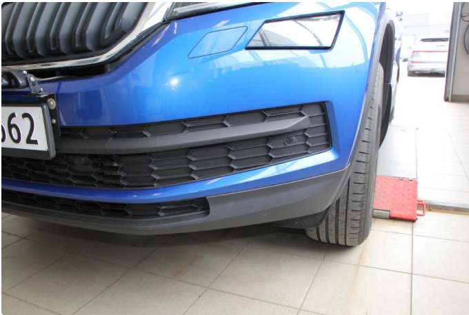
1.4 En del steinsprut i støtfanger.
