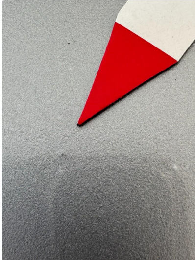
1.2 Liten steinsprut med korrosjon.
