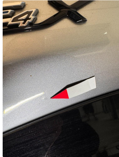
1.2 Liten steinsprut med korrosjon.
