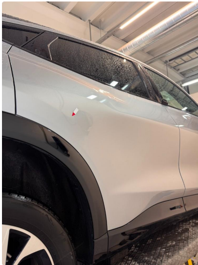
1.2 Liten steinsprut med korrosjon.
